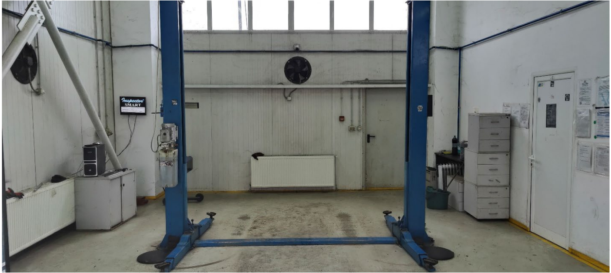
1. Elevator 2 coloane cu capacitate de ridicare de 3tone
