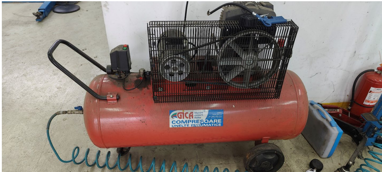
5. Compresor de aer cu o capacitate de 250 litri antrenat de un motor trifaza
