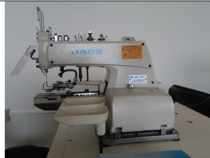
**MASINA DE CUSUT BUTONIERE DREPTE PENTRU MATERIALE SUBTIRI MEDII SI GROASE SI TRICOTAJE** - mecanism de taiere a atei, mecanism de taiere a butonierei, ridicare piciorus de max.10-12mm, obtinerea diferitelor densitati de impunsaturi, motor direct drive incorporat in capul masinii, motor cu ambreiaj – 220 V/50Hz;
